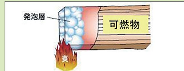
図3 ポリホウ酸ナトリウムを含浸した木材の難燃メカニズム。
