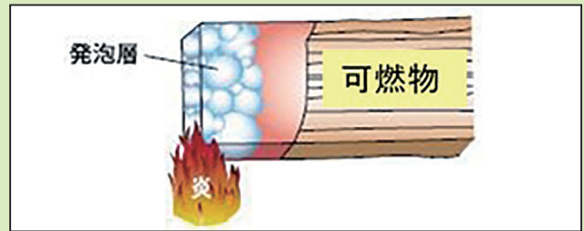
図 3 ポリホウ酸ナトリウムを含浸した木材の難燃メカニズム。
