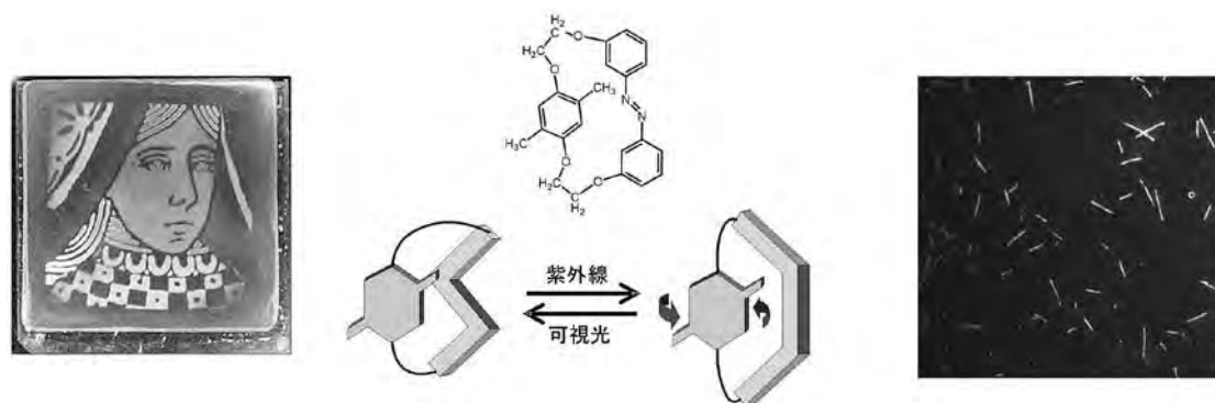
図2. コレステリック液晶の色(左)、ローターの分子内回転運動(中央)、モーター蛋白質の運動(右)、これらはいずれもアゾベンゼン部位のフォトクロミック反応で動的に制御される。
